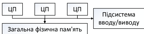
Рисунок 2 – Схема системи із SMP-архітектурою
