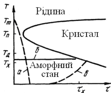
Рисунок 10 – Схема діаграми процесу утворення фаз у переохоложеному розплаві: а – критична швидкість охолодження з отриманням аморфного стану; б – ізотермічний відпал аморфного стану, що приводить до кристалізації в період часу \tau_x ; в – повільне нагрівання аморфного стану, що приводить до кристалізації при температурі T_x
