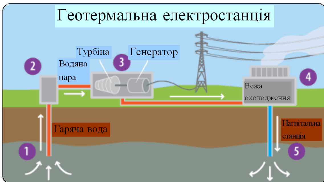
Рисунок 8 – Будова геотермальної електростанції:
